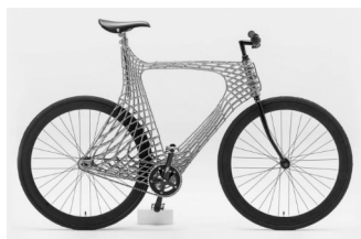
Abb.: Fahrrad in Leichtbauweise aus 3D-Metalldruck 27
