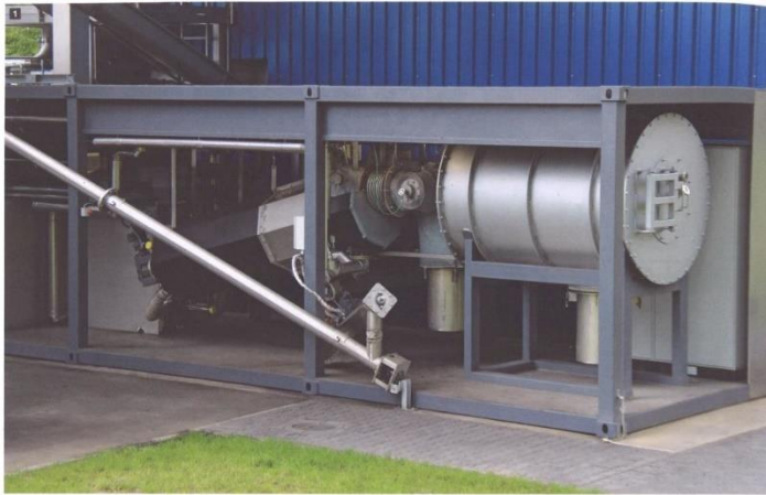
1 In der Pyreg-Anlage entsteht aus Klärschlamm Phosphordünger, der direkt von den Pflanzen aufgenommen werden kann. 2 Phosphordünger aus recyceltem Klärschlamm ist schadstoffarm. 3 Getrockneter Klärschlamm wird in der Pyreg-Anlage zu wertvollem Phosphordünger
